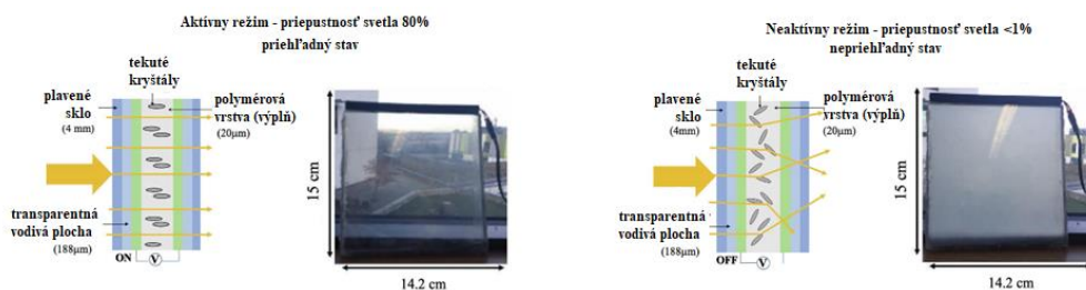
Obr. 2.14 TKRP znázornenie funkčnej schémy pre oba režimy – aktívny a neaktívny, doplnené o pohľad na vzorku zasklenia (Hemaida, Ghosh et al., 2020)
