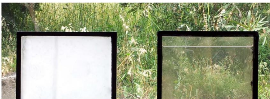
Obr. 2.9 Pohľad na PCM umiestnenom v zasklení v tuhom skupenstve, naľavo a v kvapalnom skupenstve po dosiahnutí hraničného bodu topenia PCM, (Goia, 2012)
