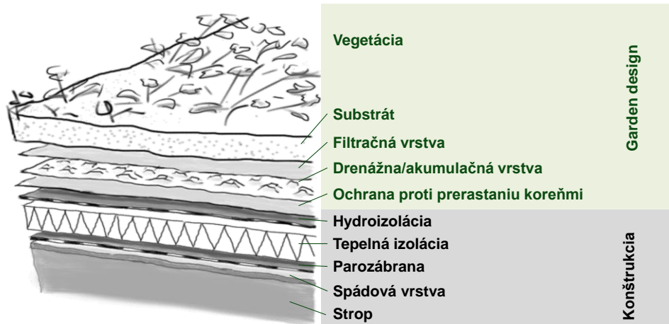
Obrázok 3 - Vrstvy typickej vegetačnej strechy (hrúbka substrátu pre extenzívnu zeleň sa zvyčajne pohybuje od 6 do 20 cm)
