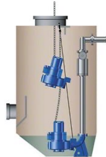
Ponorné kalové čerpadlo s usporiadaním vodiaceho drôtu
