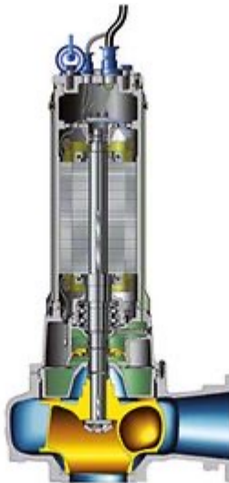
Ponorné kalové čerpadlo s jedno lopatkovým obežným kolesom
